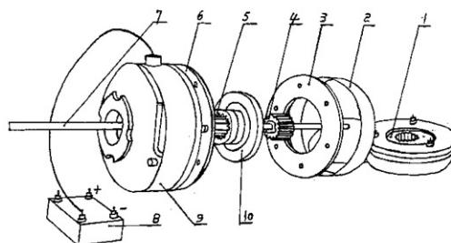
1、一种高效电磁制动器，它由制动器总成、防尘罩、摩擦片、轴套、转子、定子总成、电机轴、变压整流装置、调节螺母构成，其特征在于：变压整流装置的正负极与定子总成的正负极相连接，制动器总成、防尘罩、轴套、转子、定子总成依次安装在电机轴上。
